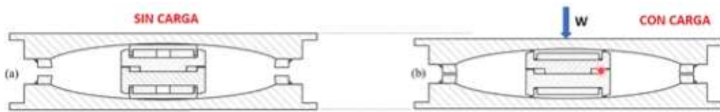
Figura 2 Dispositivo IR-FPS a) Sin carga b) Sometido a cargas
