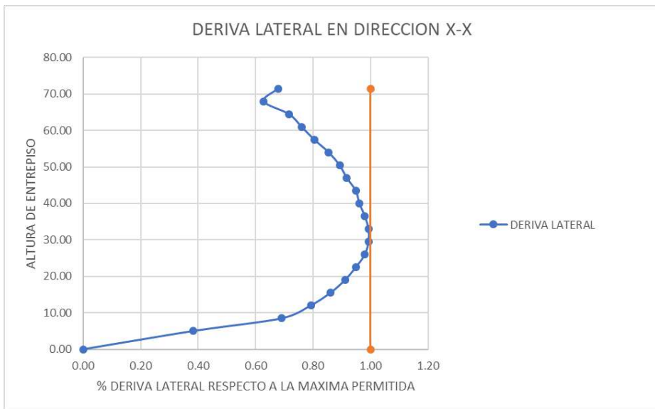
Figura 6 Deriva lateral sentido Este-Oeste al límite de cedencia con el sismo de diseño dinámico al 99% de la deriva lateral máxima permisible.
