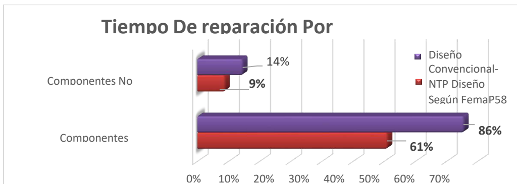
Figura 29. Tiempo de reparación por componentes (Diseño convencional vs. Diseño con FEMA P-58)
