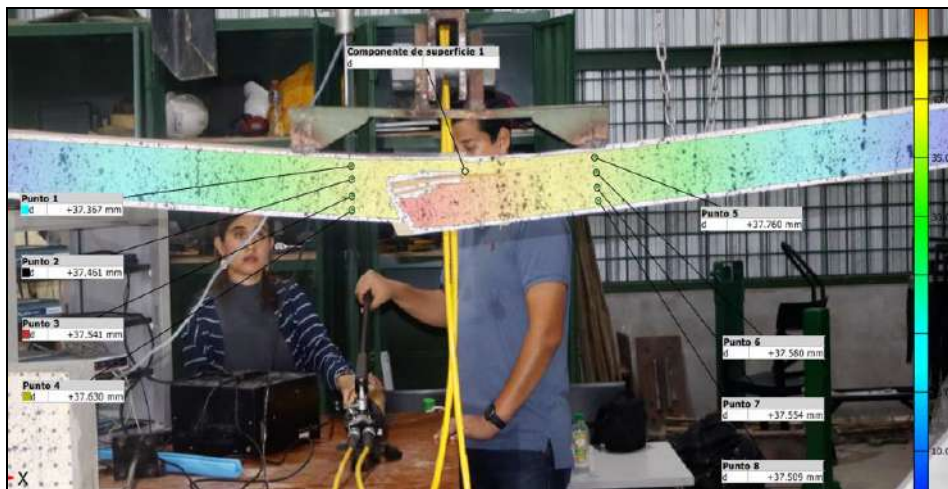
Figura 7. Distribución de desplazamiento mediante fotogrametría en la Viga 1 sin refuerzo metálico
