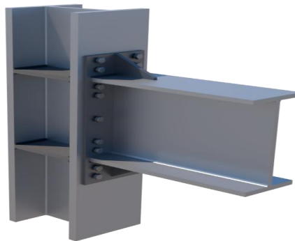
Conexión con ocho tornillos y cartabón
