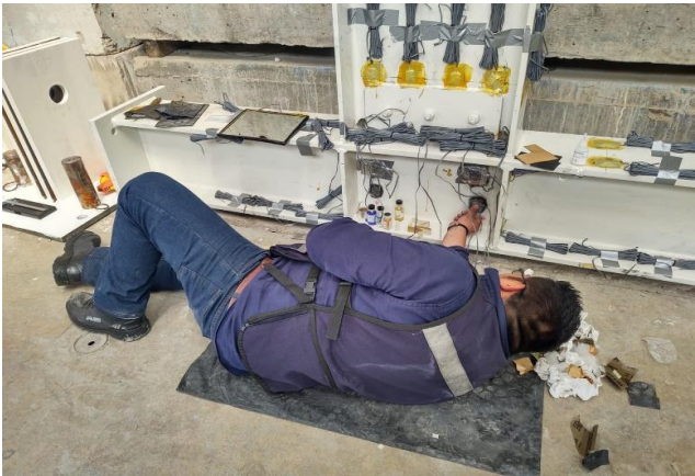
Figura 24. Instrumentación local de prototipo trabe-columna. Imagen propia.
