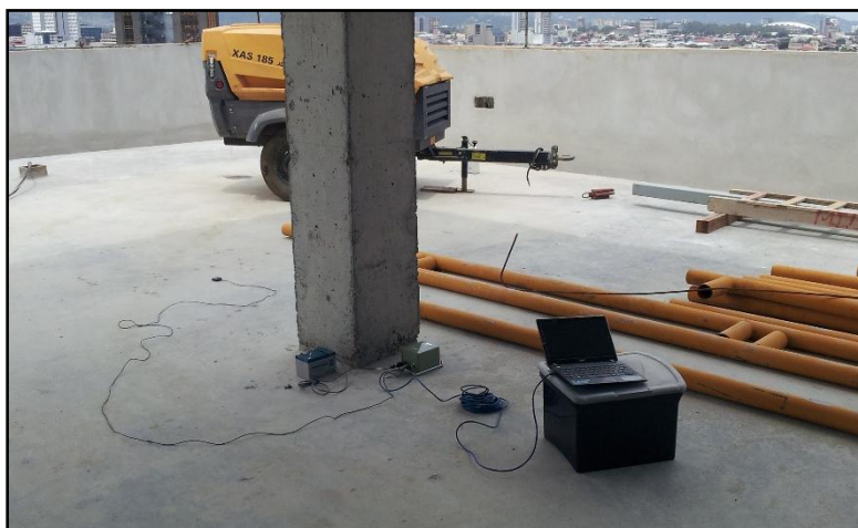
Figura 3: Acelerógrafo Nanometrics TitanSMA con accesorios, instrumentación temporal
