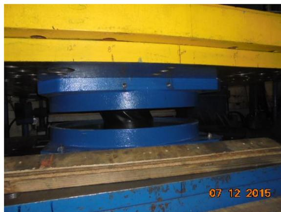
**Figura 16** Aislador FPT durante el ensayo realizado en EPS.
