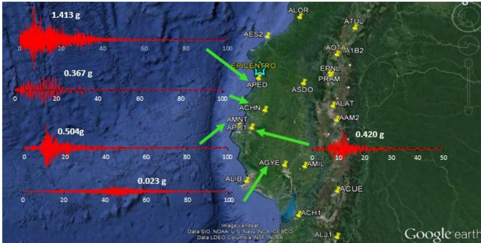
**Figura 2** Acelerogramas obtenidos del terremoto del 16 A.
