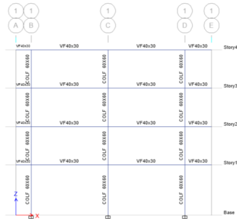
Figura 14 Pórtico en sentido Transversal
