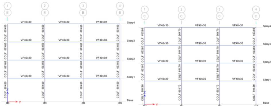
Figura 13 Pórticos en sentido longitudinal.
