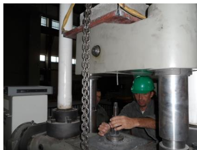
Figura 8: Varilla roscada para transmisión de carga a anclaje.
