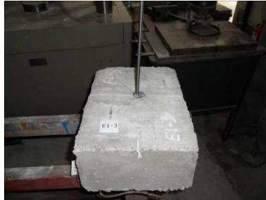
Figura 3: Bloque de hormigón sin fisurar con anclaje.
