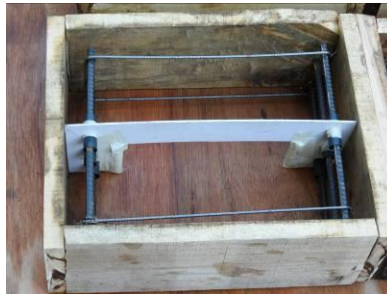
Figura 4: Inductor de fisura en molde previo al colado del hormigón.
