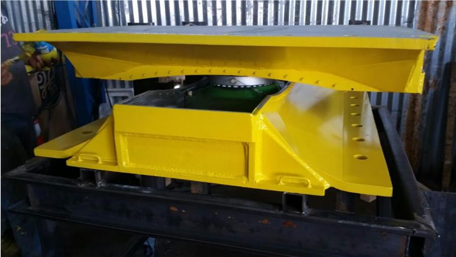
Figura A1 Aislador de Péndulo Friccional Ortotrópico PFOT para edificio de San Juan, Argentina. Fuente: SPD (2017)
