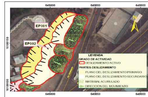
Deslizamiento No. 2. Se ubica en el sector del Panecillo, en la parroquia Luis Trujillo. Se observa en el trabajo de campo un alto grado de fracturación y meteorización. Debido a la forma cóncava de la ladera y la presencia de procesos erosivos intensos. El Cerro Panecillo se encuentra vulnerable con laderas inestables.
