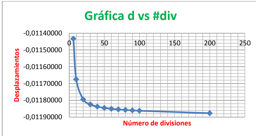
Gráfico 1. Nro. De divisiones vs desplazamientos (Viga rectangular) K_v = 431.2253 (CEINCI-LAB)
