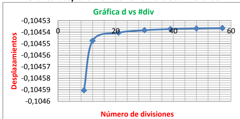
Gráfico 2. Nro. De divisiones vs desplazamientos (Viga I) K_v = 46.3223 (CEINCI-LAB)
