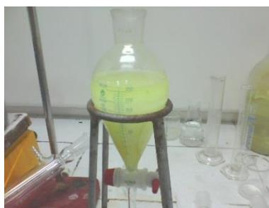
**Figura 2** Separación de dos fases miscibles en la formación del nitrobeneno
