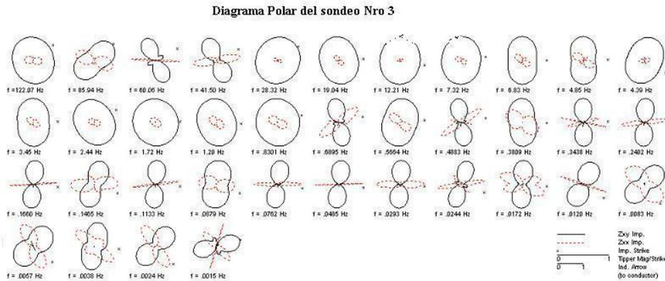
**Figura 9** Desde la 5ta.forma gráfica (28.32 Hz de izquierda a derecha) hasta, 0.8301 Hz, (segunda fila, quinta ubicación de izquierda a derecha) los diagramas polares se acercan a la forma de un círculo, denotando la estatificación cercana a la horizontal, se entiende esta forma debido a que se trata de una cuenca que fue rellenada en el periodo de distensión. Sin embargo, a mayor profundidad las estructuras van adquiriendo un modelo 2D o a 3D, indicado por la deformación de las graficas
