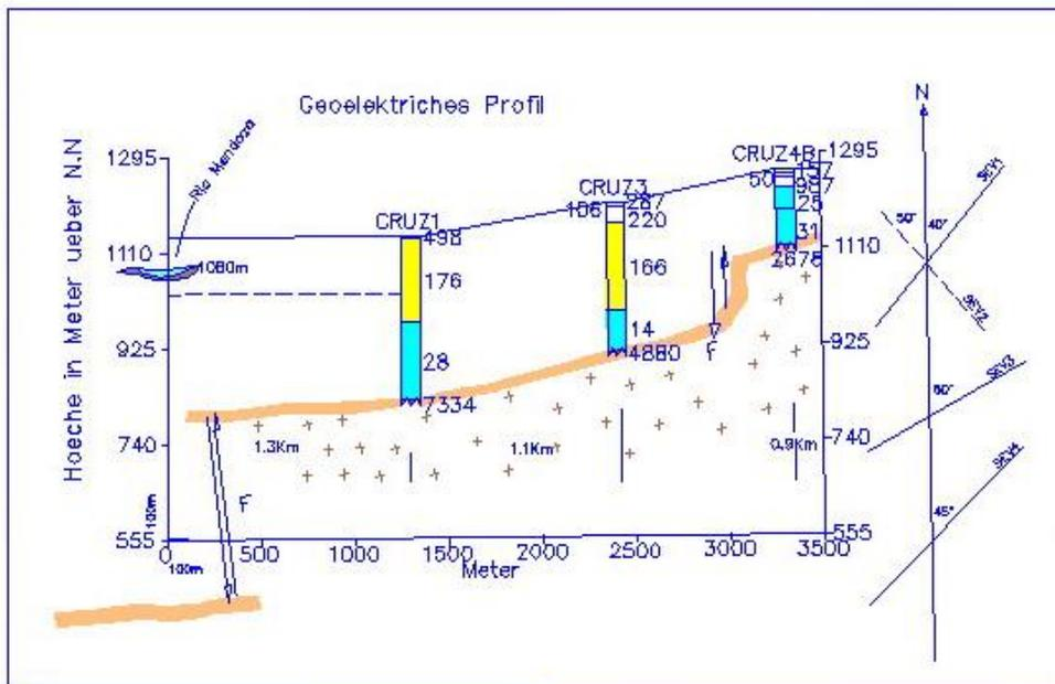
**Figura 3** Perfil geoelectrico con indicación de las resistividades provenientes del procesamiento de los datos de campo e interpretación de los estratos diferenciados.
