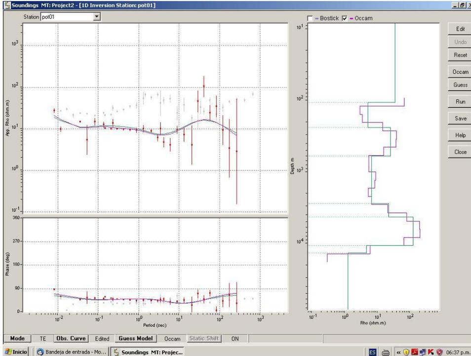
**Figura 4** Representa los resultados del procesamiento del sitio aguas arriba del dique Potrerillos, ver (Figura N° 2) los datos colectados son desde 0.01 hasta 300 seg. , arriba a la izquierda se grafica la traza de la curva resistividad aparente vs periodo, y las barras de error de los datos de campo, abajo las fases que es proporcional a la derivada de la resistividad (Vozzof, 1990), es la diferencia, frente al periodo, de la señal eléctrica y magnética.
