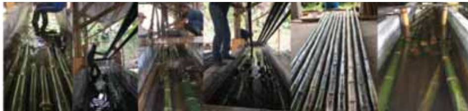
Figura 8. Proceso de preservado por inmersión-difusión, con solución a base de sales de boro.
