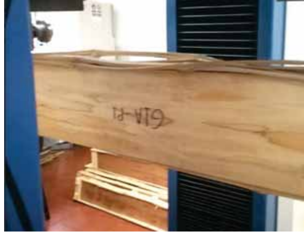
Figura 15. Deformación fibras del patin superior.
