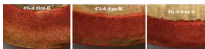
Figura 3. Resultados, detalle de penetración-presencia de SB, concentración al 4 % en 4 días, partes baja, media y alta del tallo, preservadas por inmersión-difusión. G. aculeata de la región de Hueytamalco, Puebla.
