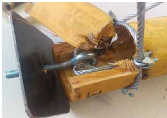
Figura 6. Falla tensión paralela a las fibras.
