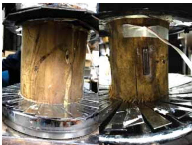
Figura 11. Tipos de fallas típicas en el ensayo de Compresión paralela a las fibras.
