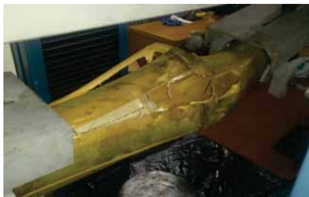
Figura 24. Falla típica del ensayo de flexión.
