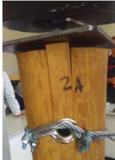
Figura 5. Falla tipo bloque de cortante.
