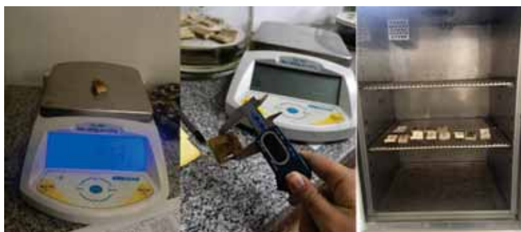
Figura 27 Equipos utilizados para el ensayo de densidad.
