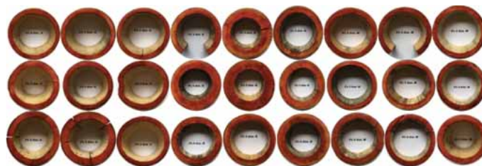
Figura 2. Resultados de la evaluación penetración y presencia de SB, al 4 %, en 4,5 y 6 días en las partes baja, media y alta del tallo, preservadas con SB por inmersión-difusión. G. aculeata de la región de Hueytamalco, Puebla.
