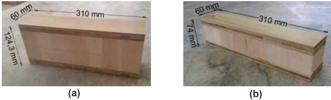
Figura 5. Muestras de tablero estructural compuesto tipo sándwich para pruebas de corte (a) muestra nominal del prototipo 1 y (b) muestra nominal del prototipo 2.
