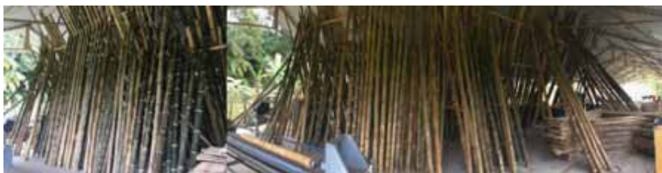
Figura 9. Proceso de secado bajo sombra tallos rollizos, esterilla y reglilla.
