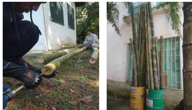
Figura 2. Perforación de los nudos (izquierda) y tratamiento de los culmos por inmersión vertical (derecha).
