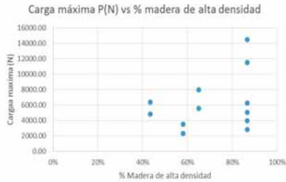
Figura 12. Carga máxima vs porcentaje de madera de alta densidad.
