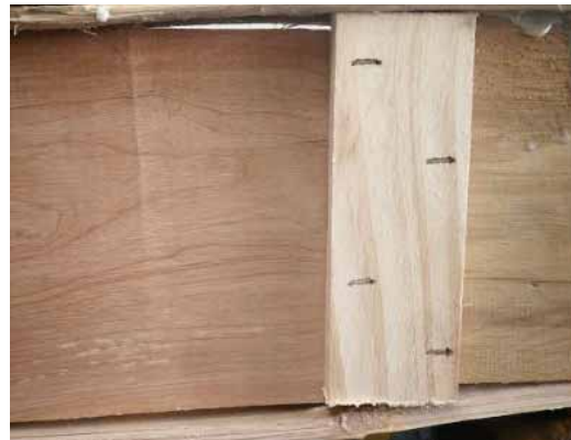
Figura 16. Desplazamiento relativo piezas de madera reutilizada.
