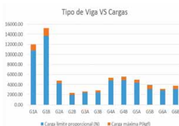
Figura 20. Tipo de viga vs carga máxima y carga en el límite proporcional.
