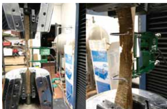
Figura 15. Tipos de fallas típicas en el ensayo de Compresión paralela a las fibras, montaje de extensómetro
