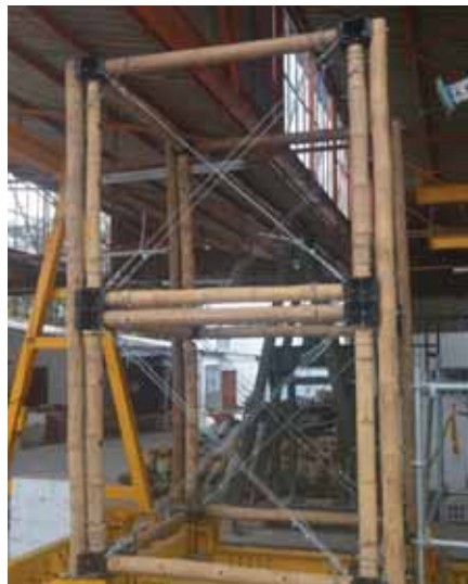
Figura 11. Módulo espacial de dos pisos.
