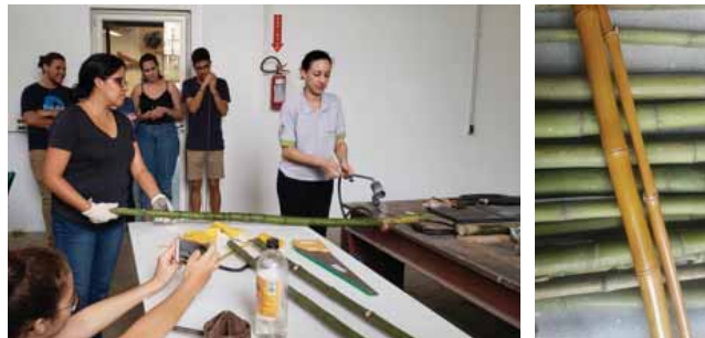
Figura 4. Tratamiento del bambú con fuego (izq.) y cambio de color de los culmos tratados (der.).
