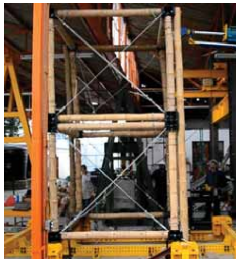
Figura 15. Verticalidad de nivel 1 y columnas de unión.
