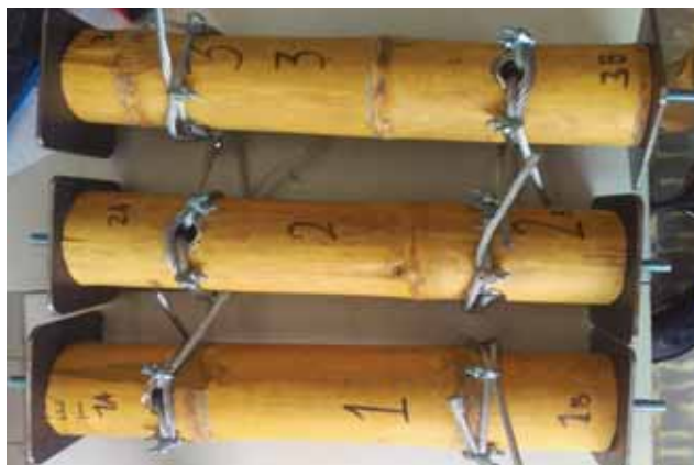
Figura 4. Probetas ensayo conexión sencilla.
