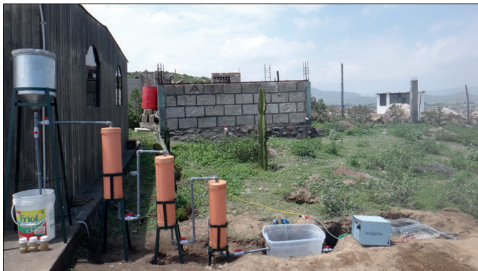
Figura 1. Modelo de sistema escala para el tratamiento de aguas residuales de granja de porcinos.
